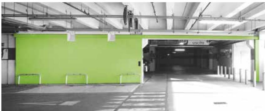
**Porte scorrevoli orizzontali rigide** EI 60 e EI120, a una o due ante. Misure massime di passaggio **10.000 mm x 8225 mm** a singola anta e **5600 mm x 5000 mm** a doppia anta con massima superficie certificabile. Entrambe le soluzioni con massima superficie certificabile CE di 50 m<sup>2</sup> come da normativa.
