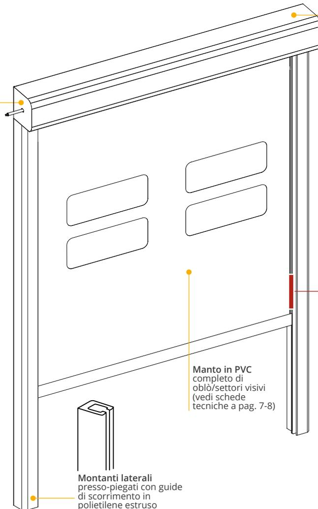
Traversa superiore carterizzata. Struttura perimetrale zincata 20/10 con zincatura 200 micron. Con eventuale sovra-verniciatura a polveri epossidiche 160/180 micron
