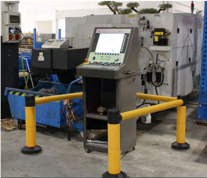
Bollards a protezione di macchinari
